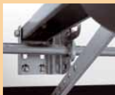
Středová konzola pro uchycení pohonu a hřídele
